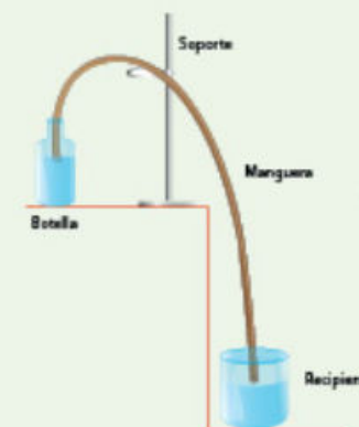
Estructura y funcionamiento de un sifón.
